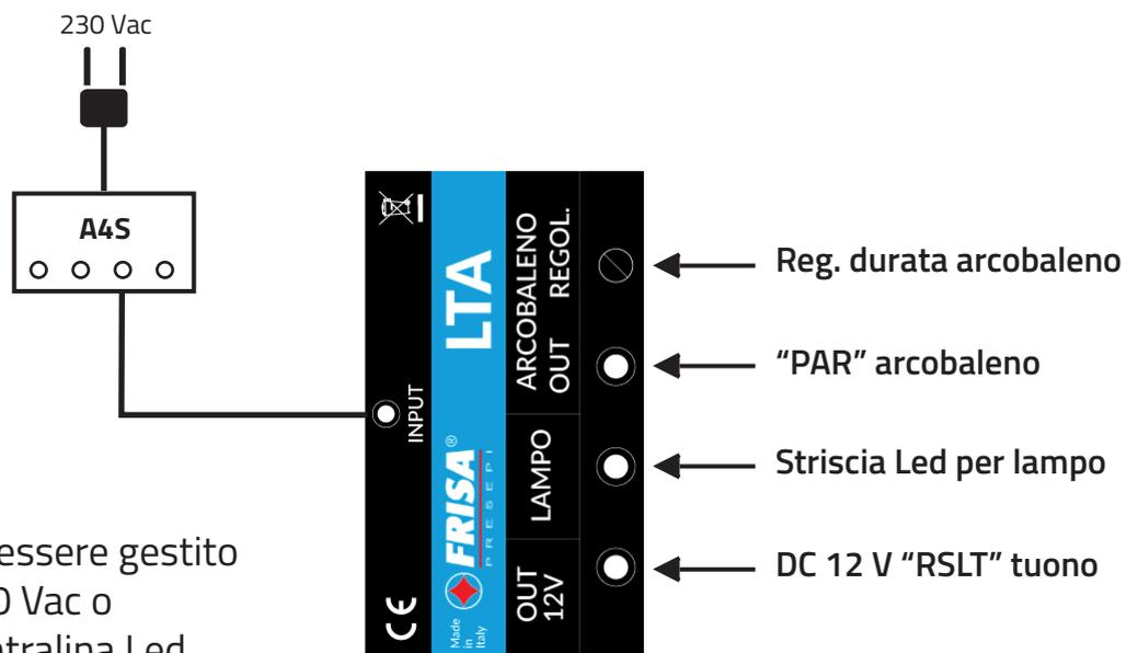
L'alimentatore potrà essere gestito da una centralina 230 Vac o sincronizzato alla centralina Led mediante l'utilizzo di una presa "SYL".
