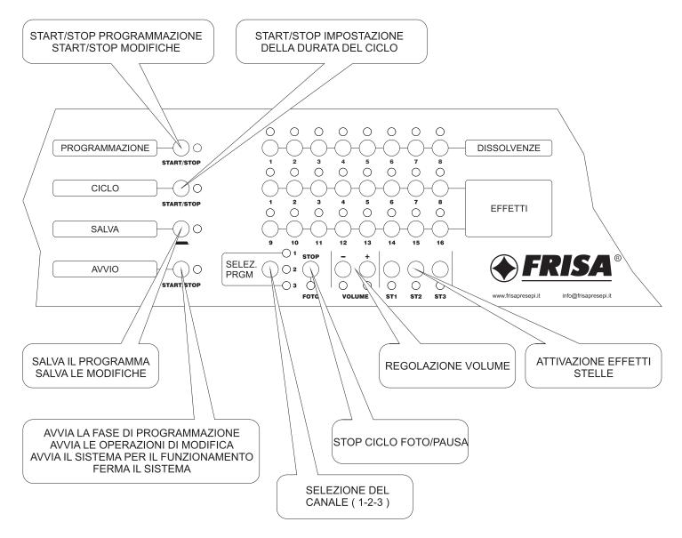
La centralina può essere programmata senza il collegamento di alcun accessorio, ma per poter eseguire un buon lavoro è certamente utile dotarsi delle lampade e/o degli effetti da collegare nelle varie uscite. Si avrà una visione ancora migliore collegando alla centralina l'impianto scenico che dovrà essere gestito. Sarà inoltre necessario collegare l'impianto audio mediante il quale si ascolta la base musicale sulla quale effettuare la programmazione.
