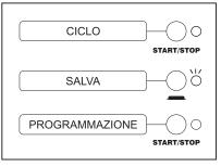
8) A fine programmazione premere STOP "CICLO"; poi "SALVA": due lampeggi del led relativo indicheranno che il programma è stato salvato sulla penna USB con il nome "FRISA1.TXT". Uscire dalla programmazione premendo il tasto "PROGRAMMAZIONE"
