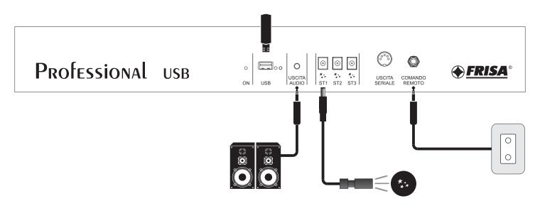
**ON**: si illumina all'accensione; inizialmente segue il caricamento del programma, poi resta acceso indicando che la centralina è in funzione.
